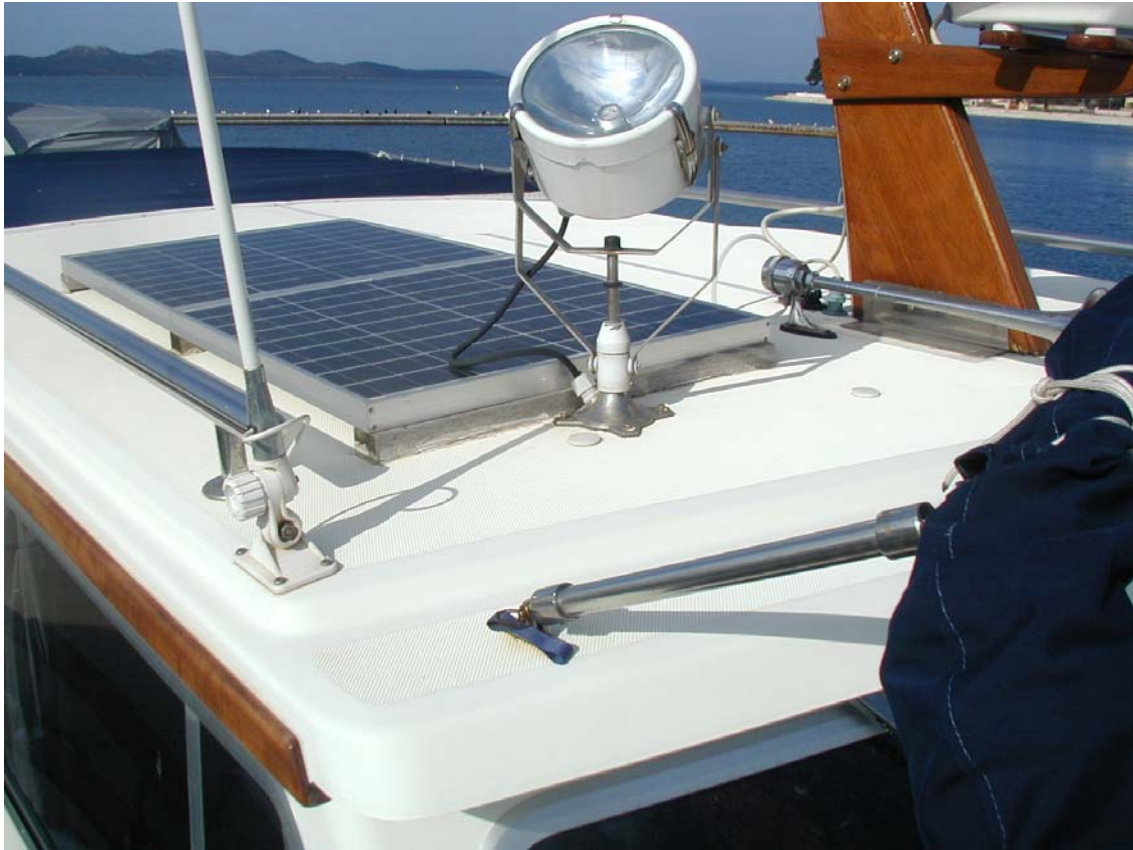
Postojeći solarni sustav nedovoljne snage 2 x 60 W
