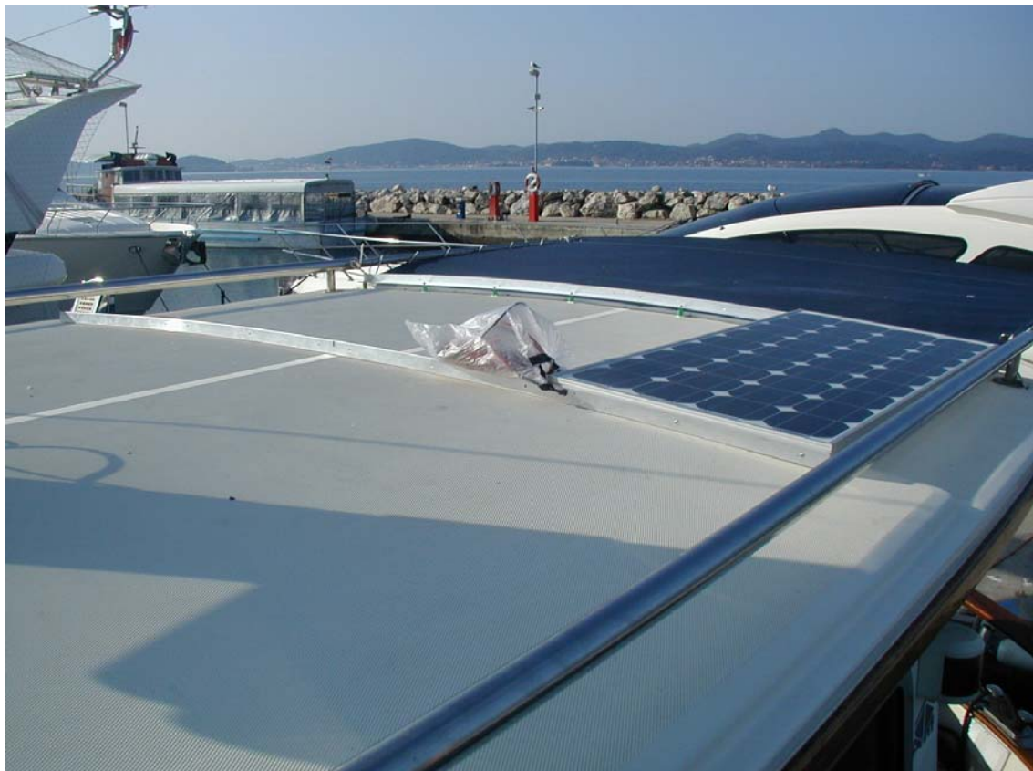
Postojeći solarni sustav nedovoljne snage 2 x 60 W
