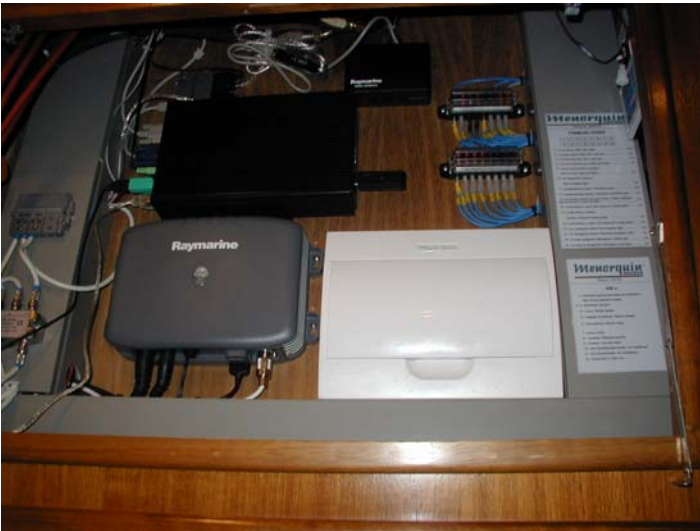
Menorquin 16, Murter, Brodski PC ugrađen među ostalu elektroničku opremu i povezan sa svim brodskim senzorima i instrumentima i autopilotom
