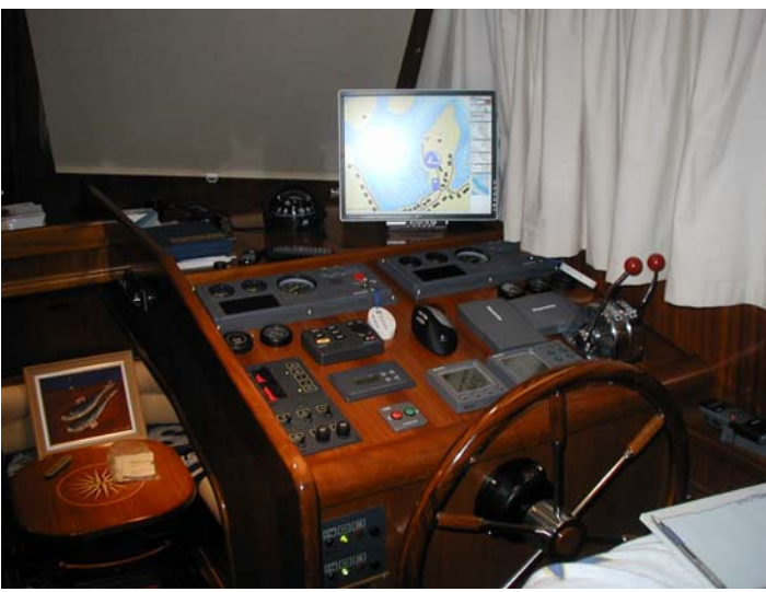
Menorquin 16, Murter, Brodski PC i NavPro, TV tuner, TV instalacija na 4 mjesta, Internet, paralelna navigacija sa postojećom na brodu, spojeni svi brodski instrumenti na PC i NavPro
