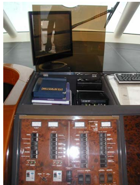
Princess 44, Murter, Brodski PC i NavPro, spojeni svi brodski instrumenti i autopilot na PC i NavPro
