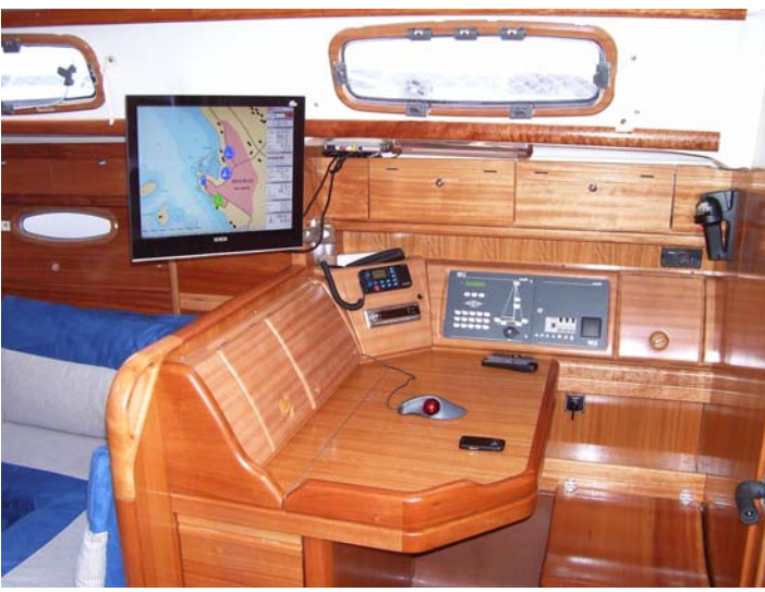
SY Bavaria 46, Biograd, Brodski PC i SmArtNav, Internet, spojeni svi brodski instrumenti i autopilot na PC i SmArtNav
