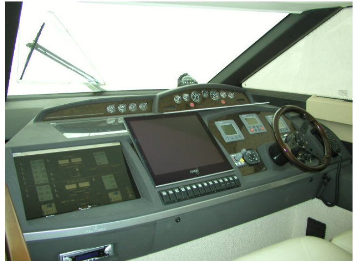
Princess 44, Murter, Brodski PC i NavPro, spojeni svi brodski instrumenti i autopilot na PC i NavPro
