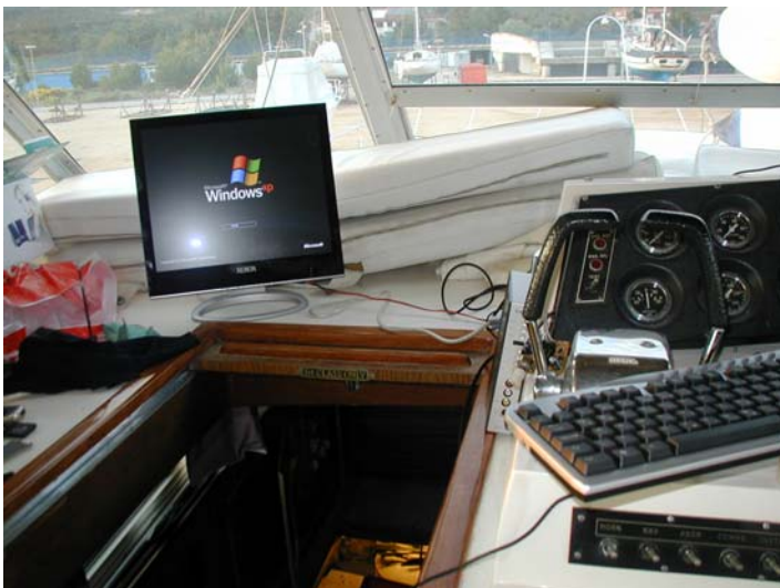
MY Mrvica, Zadar, Brodski PC i SmArtNav Pro, Internet, spojeni svi brodski instrumenti i autopilot na PC i SmArtNav Pro
