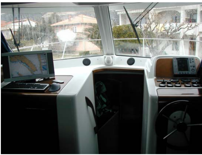
MY Benettau 35, Novalja, Brodski PC i NavPro, Internet, spojeni svi brodski instrumenti i autopilot na PC i NavPro
