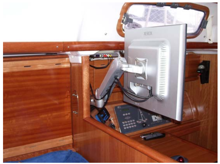
SY Bavaria 46, Biograd, Brodski PC i SmArtNav, Internet, spojeni svi brodski instrumenti i autopilot na PC i SmArtNav
