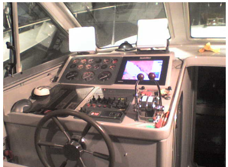
Ribarska brodica 10m, Krk, Panel PC i SmArtNav, Internet, spojen na ostale brodске instrumente
